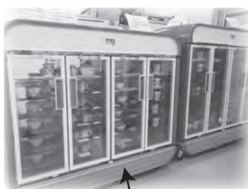
温冷の仕切り
